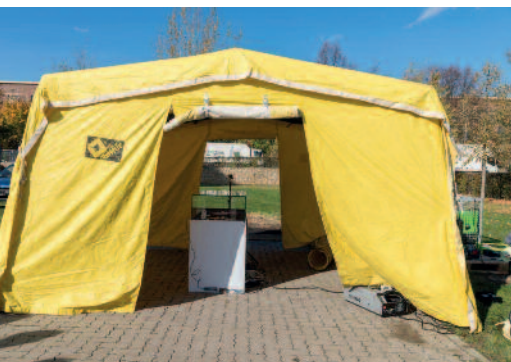
Versuchsaufbau zur Ermittlung der Rauchdichte einer Vitrine
