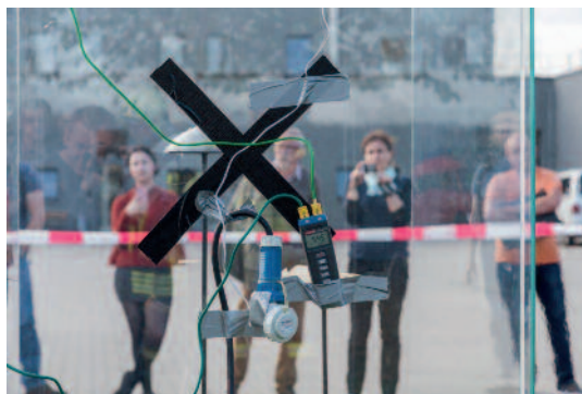
Innen und außen angebrachte Sensoren messen die Entwicklung der Temperatur im Inneren des Schaukastens
