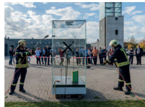
Gleichzeitiges Beflammen der Vitrine mit zwei Propangasbrennern
