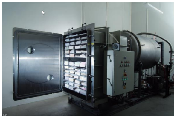
Abbildung 12: Gefriertrocknungsanlage ZFB GmbH (entnommen aus: Kobold / Moczarski, Bestandserhaltung. Foto: Brigitta Kowsky, Oliver Messerschmidt).
