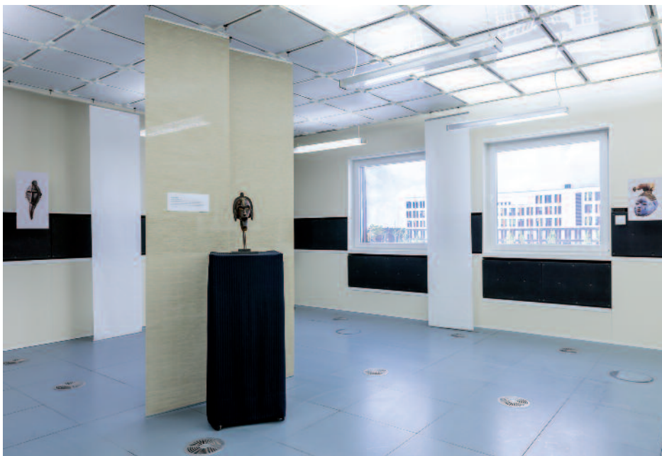
Raum-Labor mit einstellbarer Hörumgebung zur Untersuchung von Auswirkungen der Museumsakustik auf die Besucher; © Fraunhofer-Institut für Bauphysik IBP
