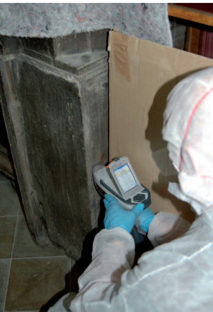
Schadstoffscreening mittels portabler Röntgenfluoreszenzanalyse im Möbeldepot.
