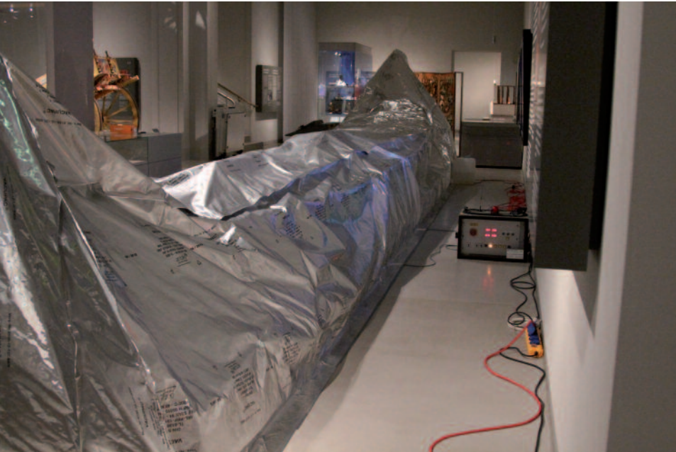
Anoxia-Behandlung einer venezianischen Gondel mittels Sauerstoffabsorber in der Dauer- ausstellung; © Rathgen-Forschungslabor
