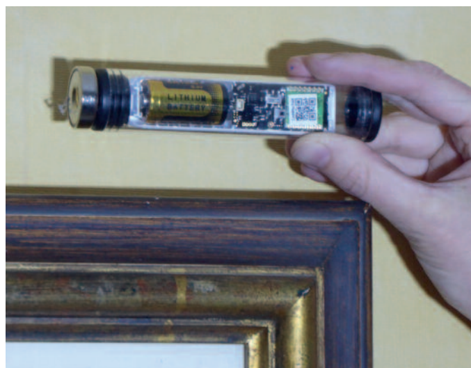
Sensor SS-07 Schutzart IP64. © INAU Elektronik
