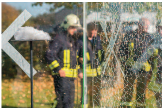
Beim abrupten Abkühlen durch das Löschwasser bilden sich weitere Risse im Verbundsicherheitsglas
