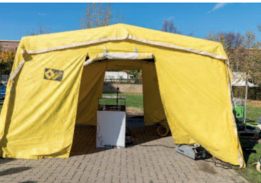
Versuchsaufbau zur Ermittlung der Rauchdichte einer Vitrine
