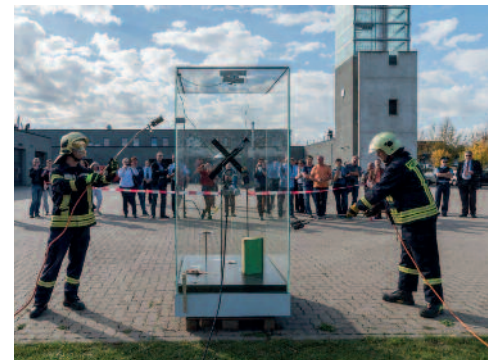
Gleichzeitiges Beflammen der Vitrine mit zwei Propangasbrennern
