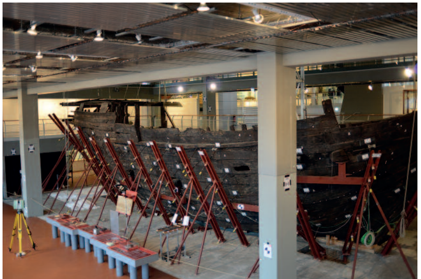
„Bremer Kogge“ mit Stützstreben während der Dokumentation mit einem terrestrischen Laserscanner; © i3mainz / C. Justus
