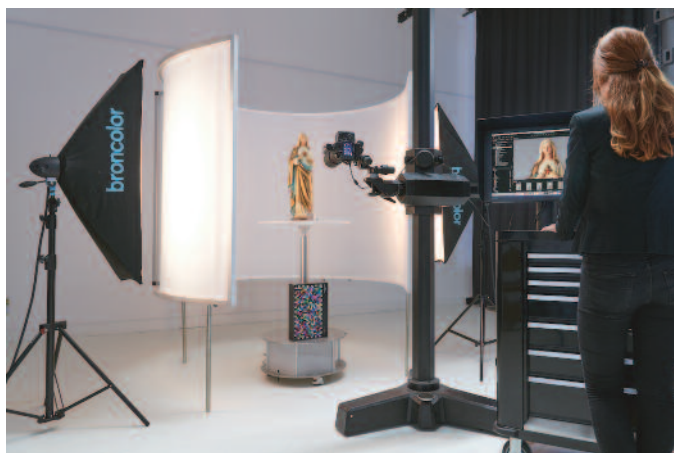
3D-Erfassung einer Madonna-Skulptur mit dem berührungsfreien Photogrammetrie-Verfahren; © Julius Fröbus GmbH
