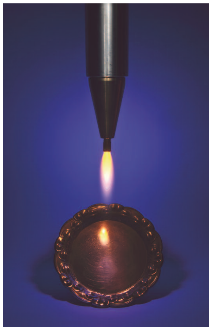
Plasmajet zur Reduktion von Silbersulfid; © Fraunhofer IST
