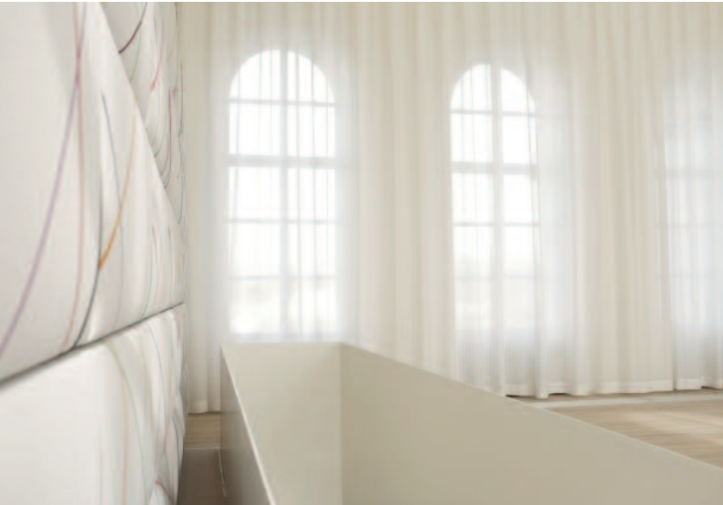
Schallabsorbierende und gleichzeitig lichtdurchlässige Vorhanganlagen im Veranstaltungssaal der Musikinsel Rheinau, Schweiz. © adtacoustics
