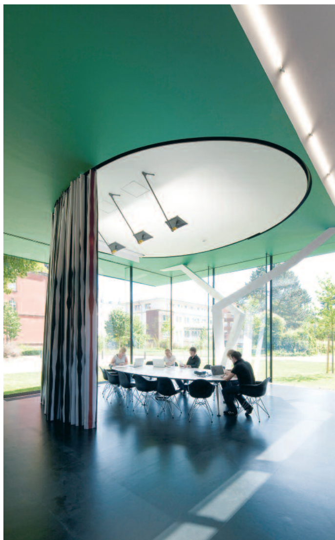
Schallvorhang für die temporäre Abgrenzung eines Besprechungsbereiches in der Bibliothek der FH Münster. © Gerriets GmbH
