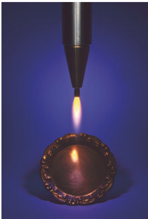
Plasmajet zur Reduktion von Silbersulfid
